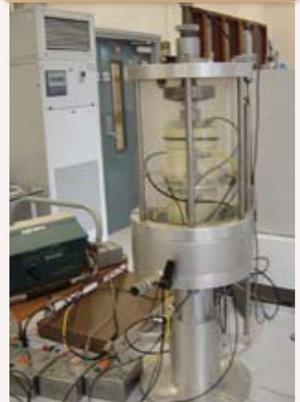
Em nosso laboratório geotécnico, dispomos de célula triaxial modificada, específica para o CPR Grouting, além da estrutura de carregamento que determina o coeficiente de pressão lateral
