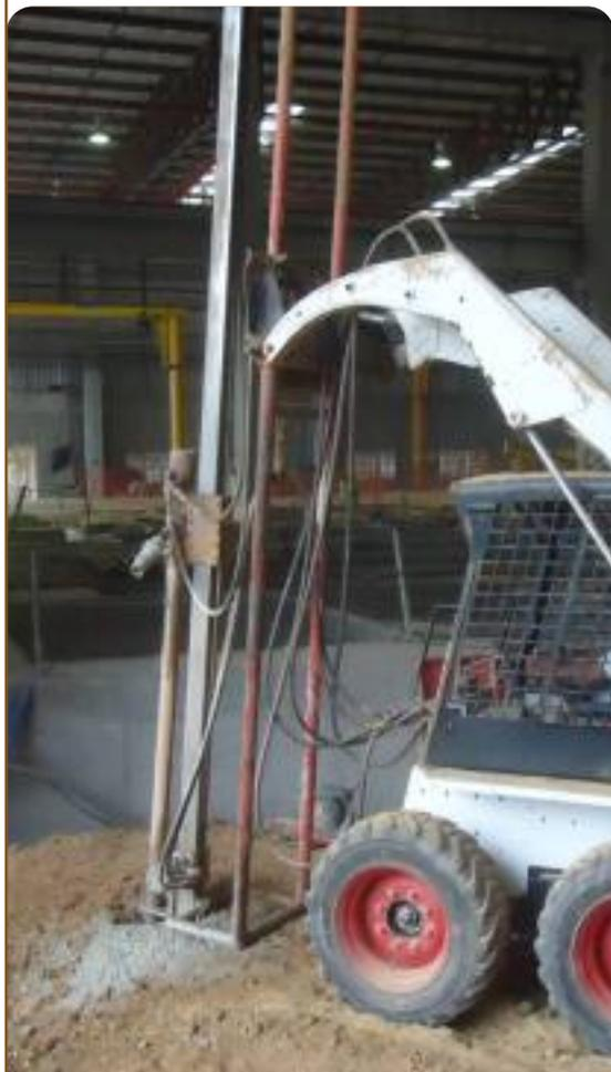
*Foram feitos ensaios Pressiométricos, antes e após tratamento CPR, entre 6,0 m e 15,0 m de profundidade. A análise dos resultados mostra que, baseado nas análises pressiométricas e piezométricas, houve melhoria geotécnica significativa no solo tratado, induzindo recalques bem superiores aos projetados e aumentando a capacidade de carga do solo de fundação. Camadas do subsolo que antes possuíam compacidade fofa adquiriram, após o tratamento, ganho de rigidez, equivalente a uma areia compacta.*
